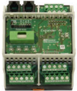
Expander module AK 4000E Code SP 5004
